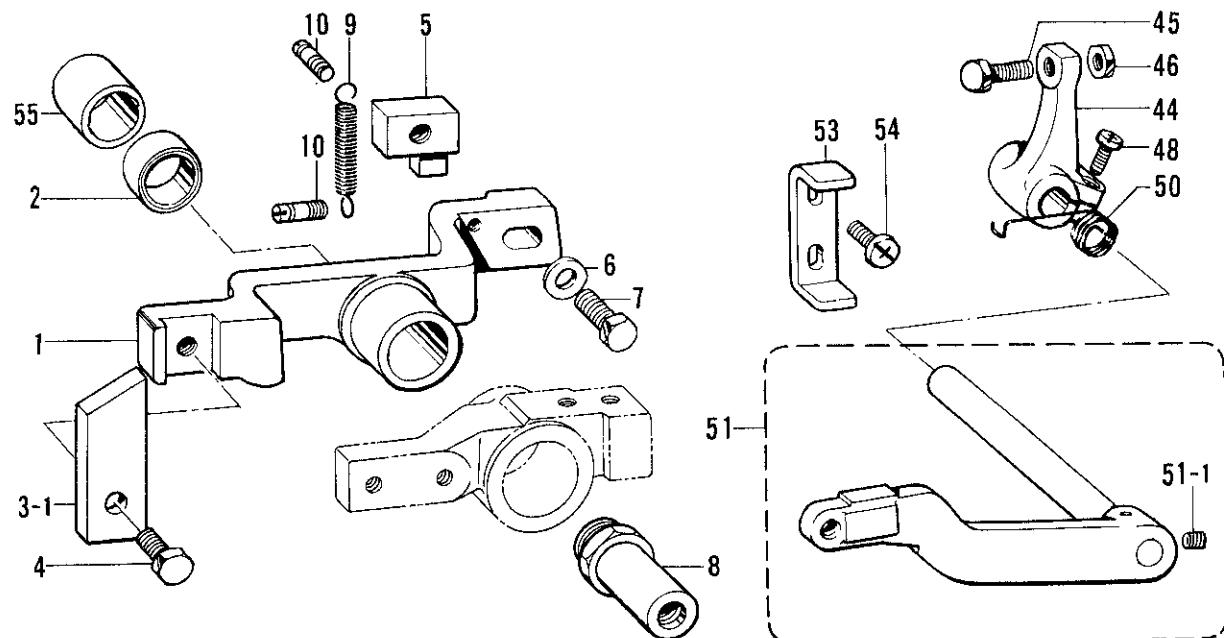
E. 停止関係 / Clutch mechanism / Kupplungsvorrichtung /
