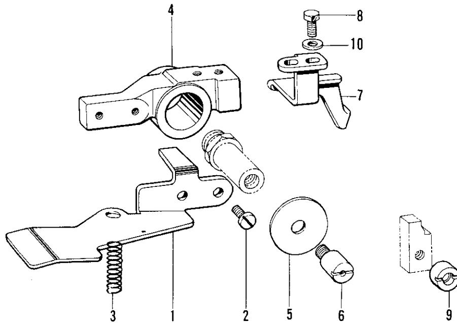
J. テンションプーリ関係/Tension pulley mechanism/Spannrolle/
