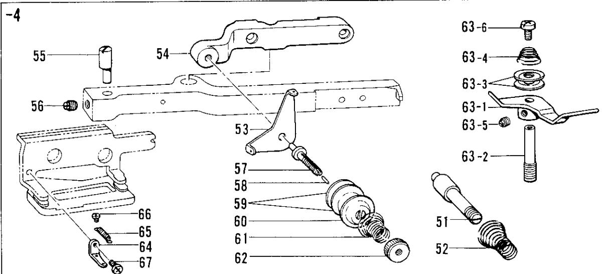
U. 糸通シ関係 / Threading mechanism/Fadenführungs vorrichtung/
