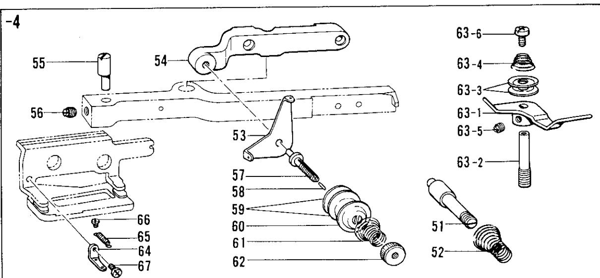
**U. 糸通シ関係 / Threading mechanism / Fadenführungs vorrichtung /
