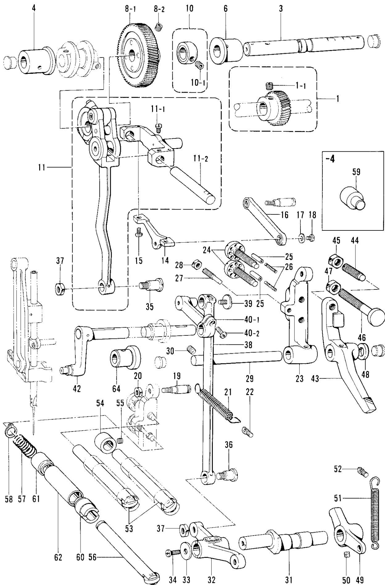
D. 針振関係 /Zigzag mechanism/Zickzackvorrichtung/
