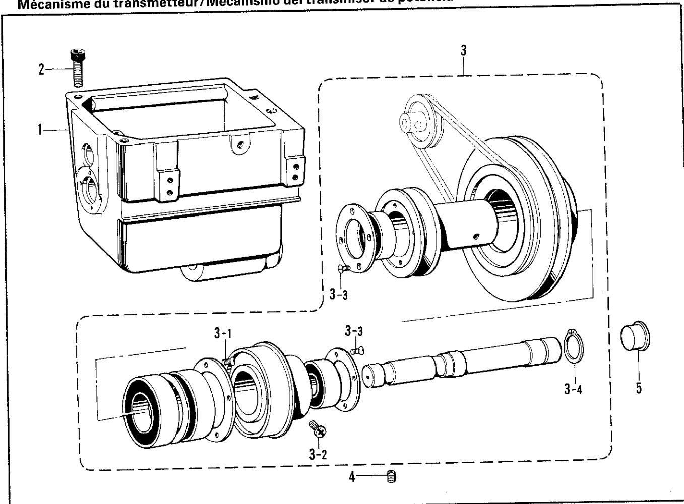
G. ベルト寄せ関係 / Belt shift mechanism/Riemenumstellvorrichtung/
