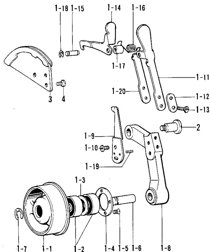
H. 非常停止関係 / Emergency stop mechanism / Abschaltvorrichtung /
