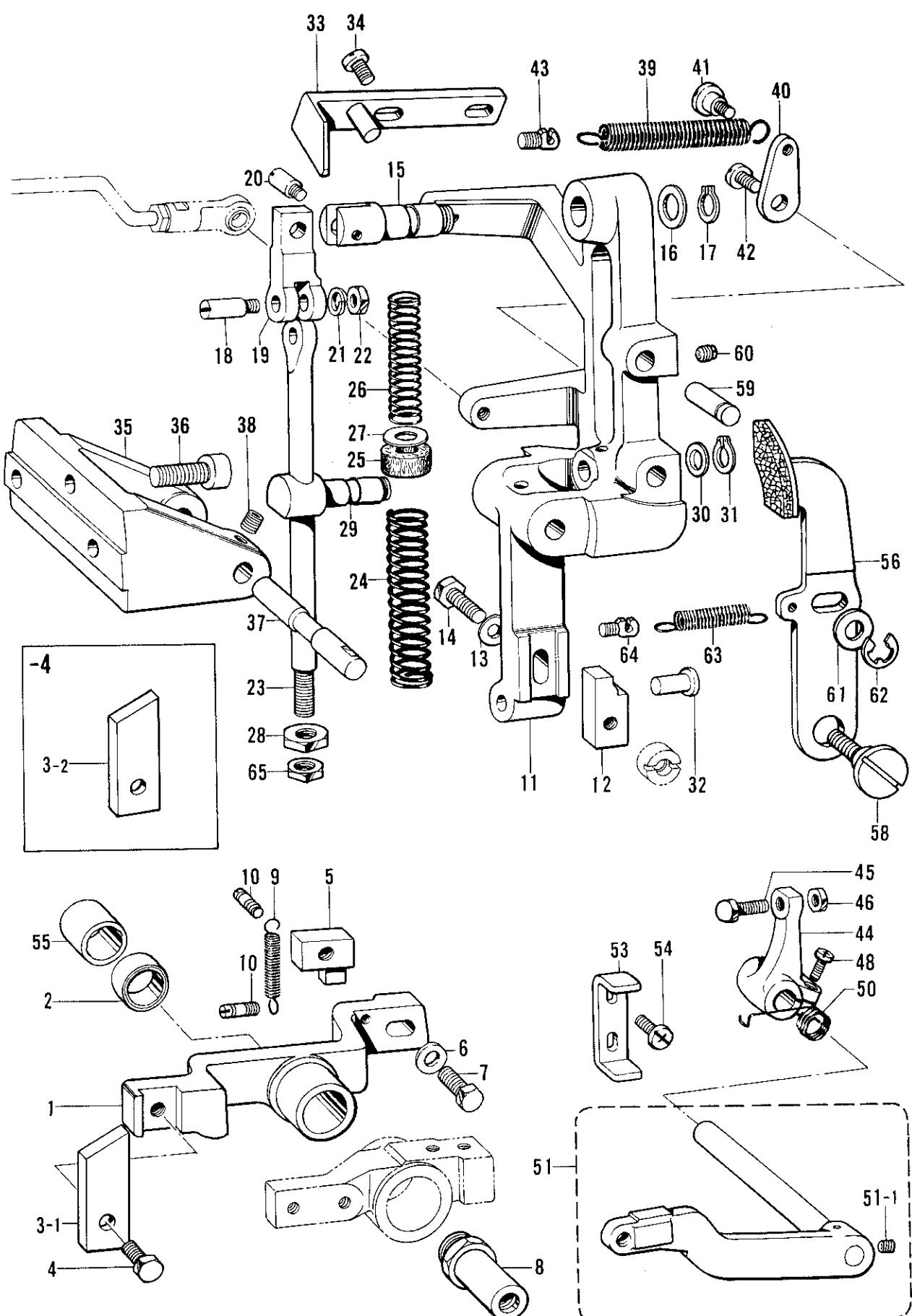
E. 停止関係 /Clutch mechanism/Kupplungsvorrichtung/
