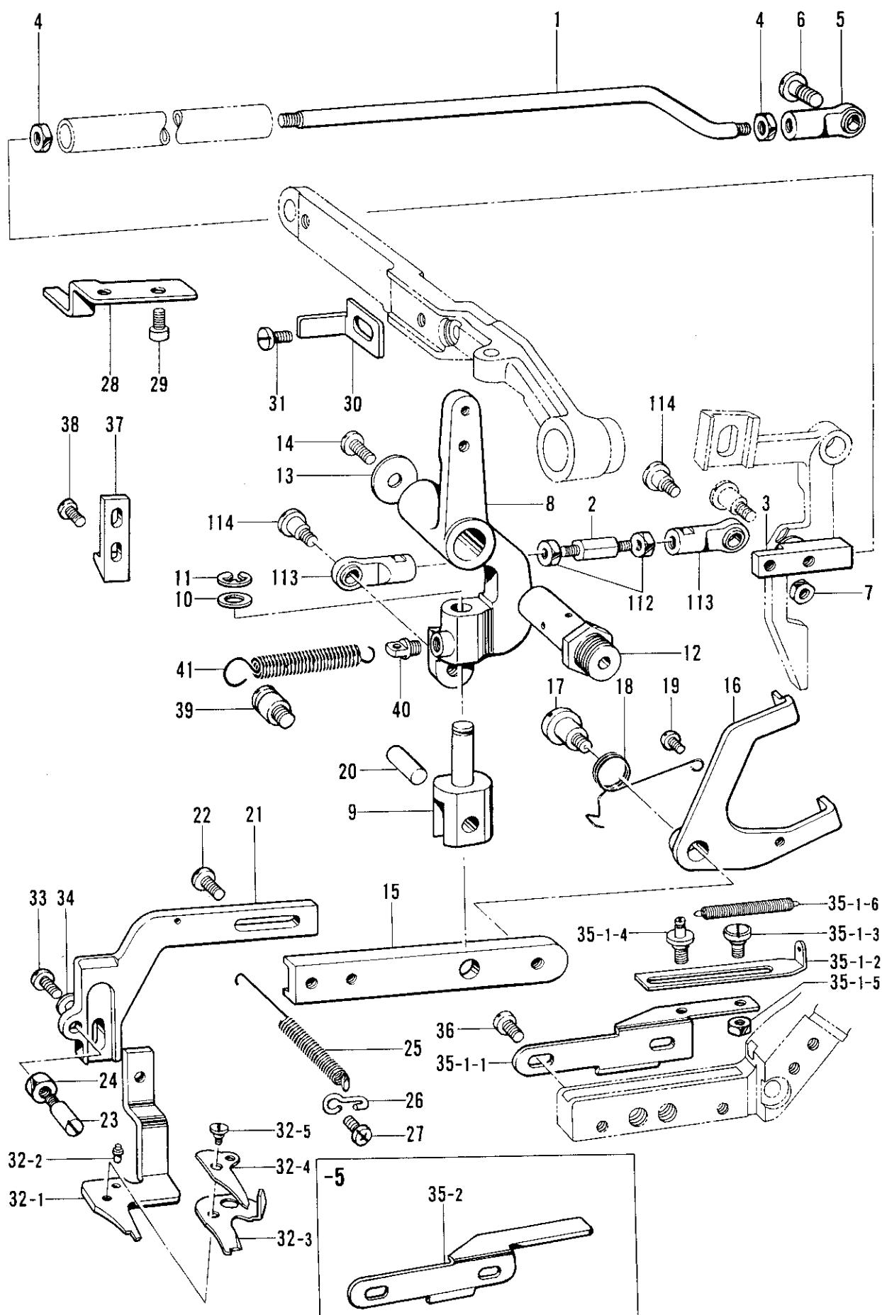
W. 上糸切り関係 (1)/Upper thread trimmer mechanism (1)/Oberer Fadenabschneider (1)/
