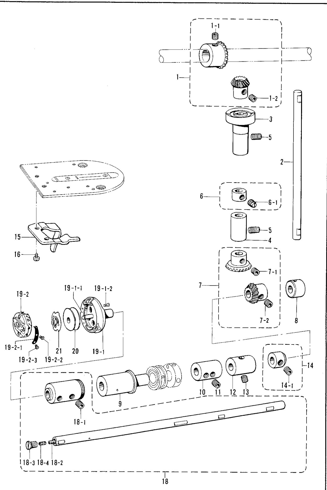
S. タテ軸・下軸関係 / Vertical shaft and lower shaft mechanism / Armwellen Und Greifermechanismus /
