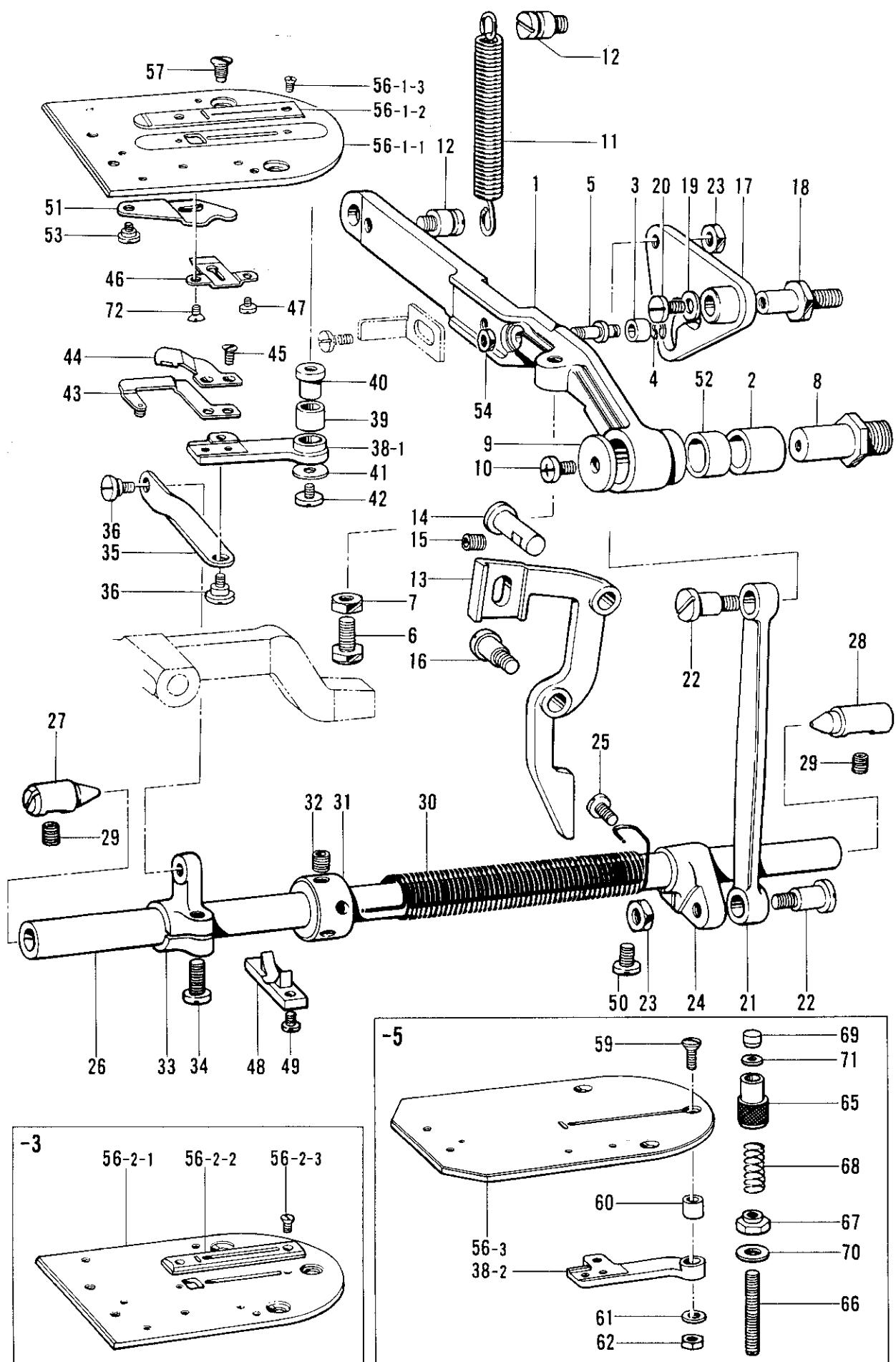
X. 下糸切り関係 / Lower thread trimmer mechanism / Unterer Fadenabschneider /
