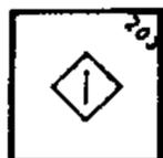
Aufhebung von STOP (Bedienpult Umbugger)
